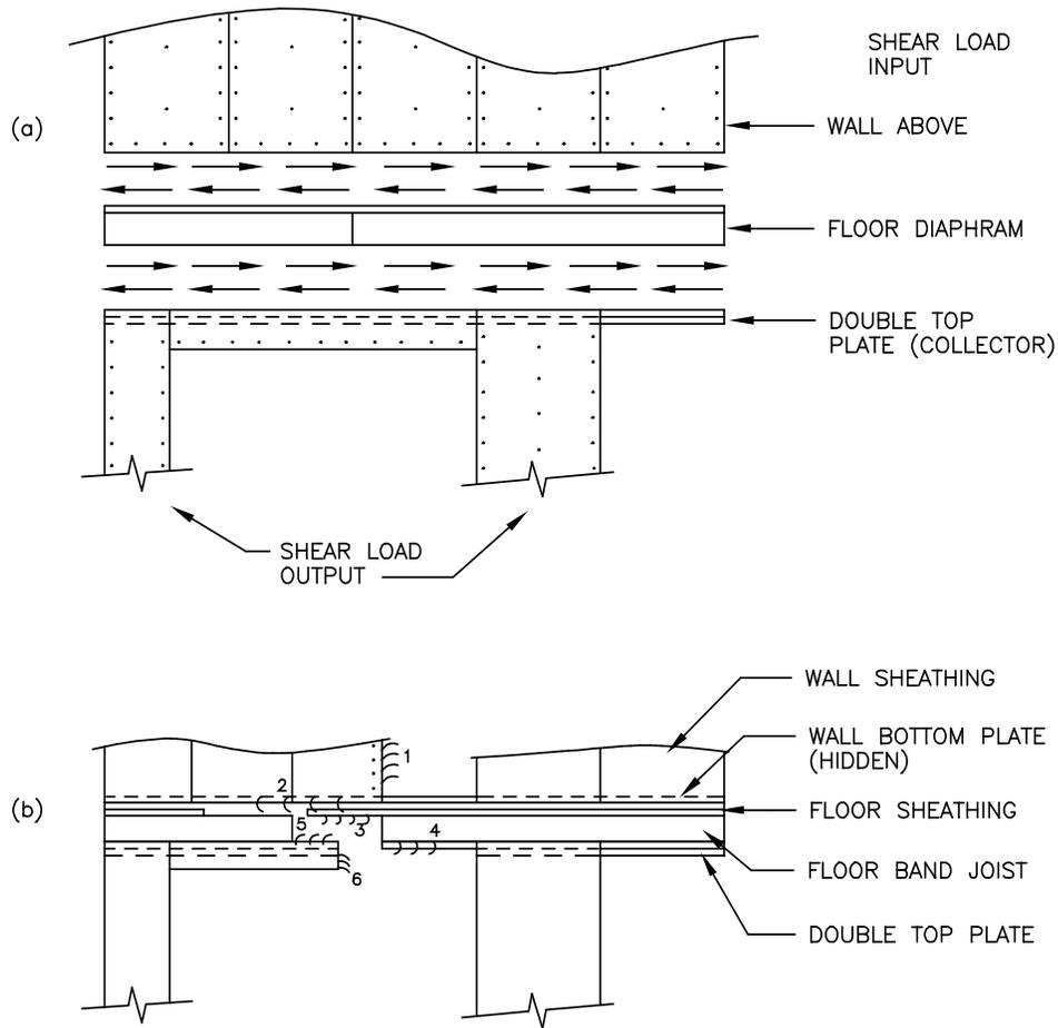
COMPOSITE FAILURE PLANE FOR A COLLECTOR:
